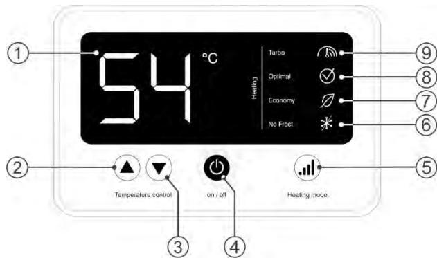
**Bild 2:** 1 – LCD-Display, 2 – knopf «▲» Temperature control / Erhöhung der Heiztemperatur, 3 – knopf «▼» Temperature control / Reduzierung der Heiztemperatur, 4 – knopf «on/off» / aktivieren/deaktivieren, 5 – knopf «Heating mode» / Einstellung der Heizleistung, 6 – modus knopf «No Frost», 7 – knopf «Economy» / Mindestleistung, 8 – knopf «Optimal» / Standardleistung, 9 – knopf «Turbo» / Maximalleistung.
