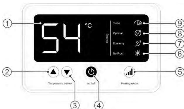
**Figure 2:** 1 – Écran LCD, 2 – le bouton «▲» Temperature control / augmentation de la température de chauffage, 3 – le bouton «▼» Temperature control / réduction de la température de chauffage, 4 – le bouton «on/off» / activation/désactivation, 5 – le bouton «Heating mode» / installation de la puissance de chauffage, 6 – le bouton de mode «No Frost», 7 – le bouton «Economy» / puissance minimale, 8 – le bouton «Optimal» / puissance standard, 9 – le bouton «Turbo» / puissance maximale.
