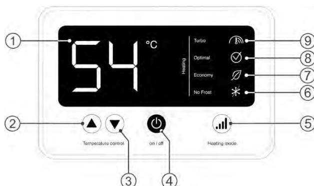
**Figuur 2:** 1 – LCD scherm, 2 – knop «▲» Temperature control / verhoging van de verwarmingstemperatuur, 3 – knop «▼» Temperature control / daling van de verwarmingstemperatuur, 4 – knop «on/off» / aan/uit, 5 – knop «Heating mode» / verwarmingsvermogen instelling, 6 – modus knop «No Frost», 7 – knop «Economy» / minimaal vermogen, 8 – knop «Optimal» / standaard vermogen, 9 – knop «Turbo» / maximale vermogen.
